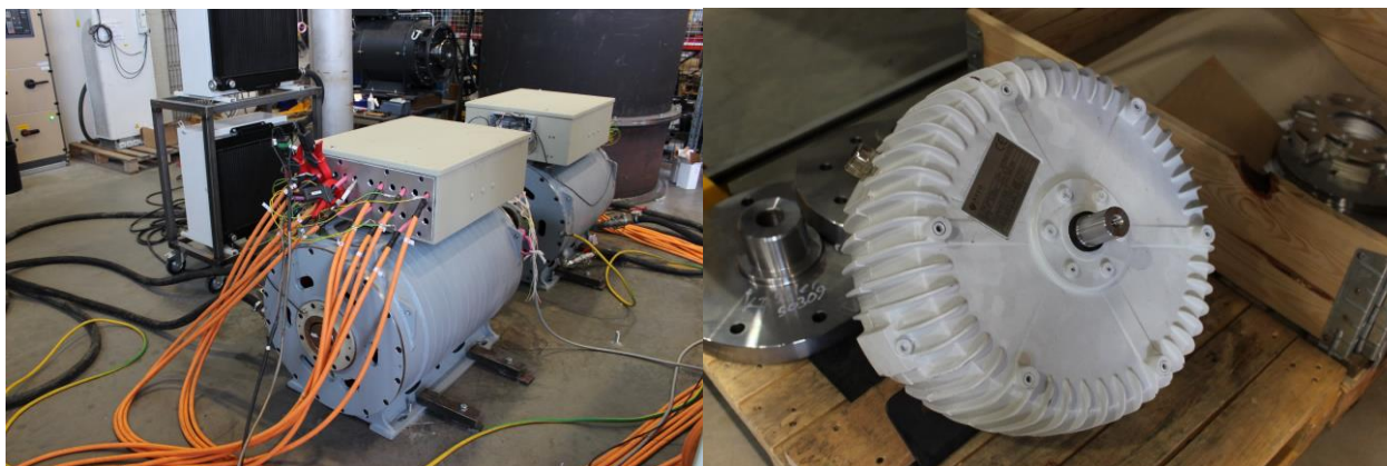
Kuva.3 Axcomotorsin testauspenkki vasemmalla / Oikealla tuuligeneraattorin prototyyppi.
